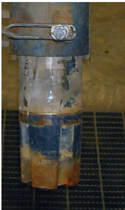
Cavidad del diafragma llena de lod Del motor mostrado a la izquierda
