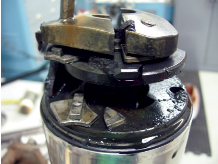
COJINTE DE EMPUJE, SOPORTE Y SEGMENTOS ROTOS
