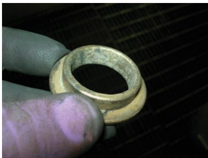
Desgaste en el DI del buje del eje No Visible
