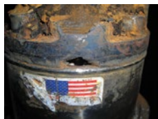
Corrosión en área de conector
