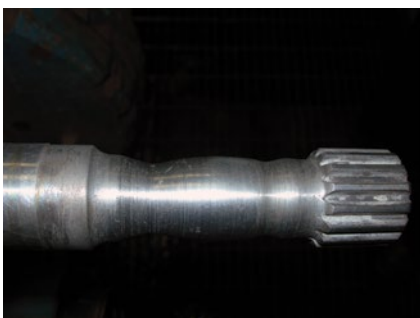
Eje con desgaste severo Visible
