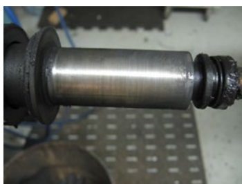
Residuos en cojinete Daño en el Eje
