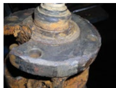
Daño por corrosión en campana
