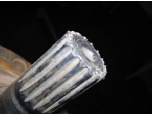
Extremo del eje con desgaste por abrasivos
