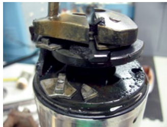
Se requiere un impacto muy fuerte para fracturar/partir los cojinetes
