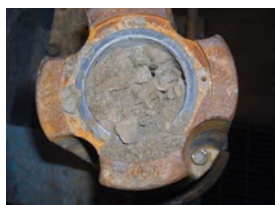
Cavidad del diafragma llena de lod Del motor mostrado a la izquierda
