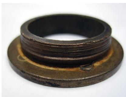
Casquillo del eje desgastado por arena Visible
