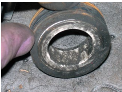
Sello cubierto con abrasivos/DI gastado No Visible
