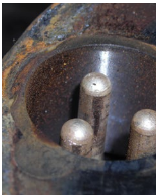
Corrosión y óxido en entrada del conector
