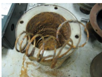
Agua agresiva/con arena o motor en arena.
