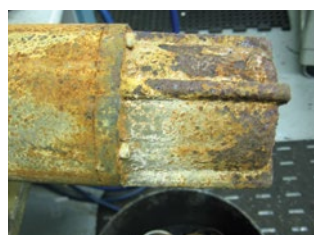
Corrosión/sarro No cubierto por garantía
