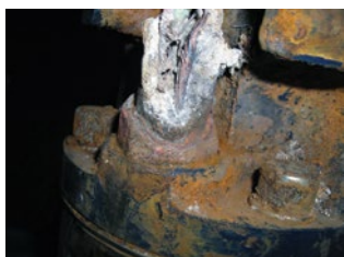
Corrosión excesiva No cubierto por garantía
