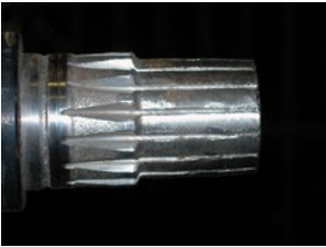
Desgaste en el estriado por abrasivos
